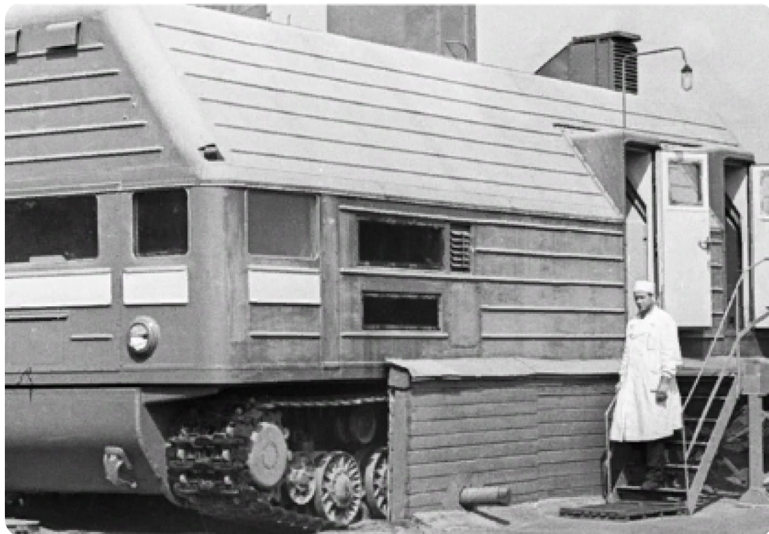
ТРАНСПОРТАБЕЛЬНАЯ АЭС МАЛОЙ МОЩНОСТИ ТЭС-3
